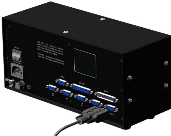
รูปที่ 8 แสดงการต่อใช้งาน RS232 และ การตั้งค่า COM PORT
